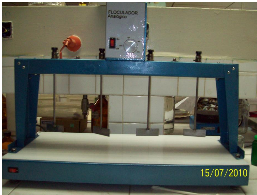
Fig. 1 Equipo de pruebas de jarras perteneciente a CIMAUC.
