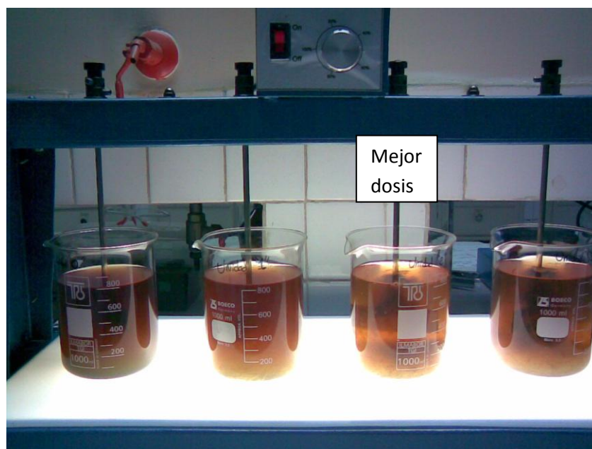
Fig. 2 Evaluación de la mejor dosis de coagulante-floculante.
