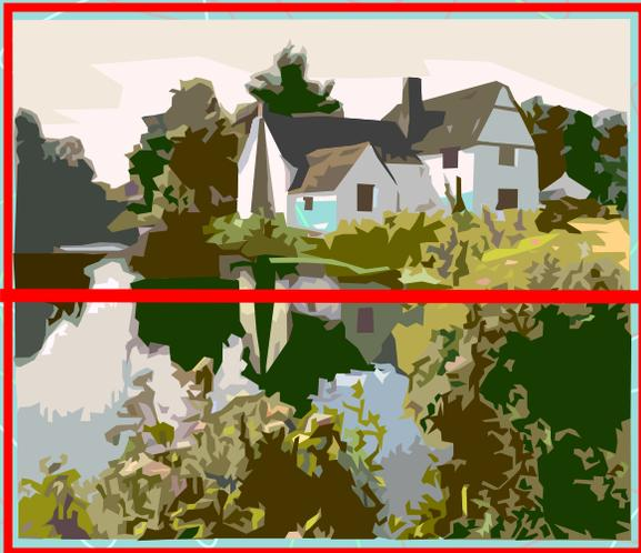
La coincidencia de las imágenes se alcanza al girar el espejo **M2** (pivote) mientras se observa la imagen en el espejo central superior haciéndola coincidir con la del espejo central inferior.
